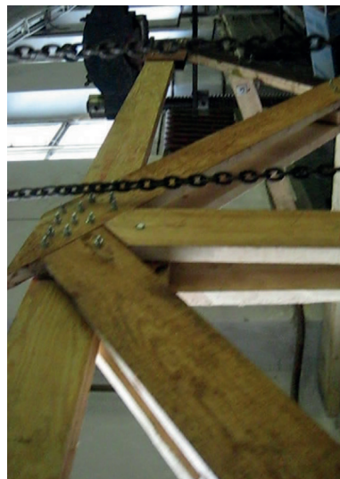
Рис. 67. Разрушение конструкции в накладках нижнего пояса от скальвания
