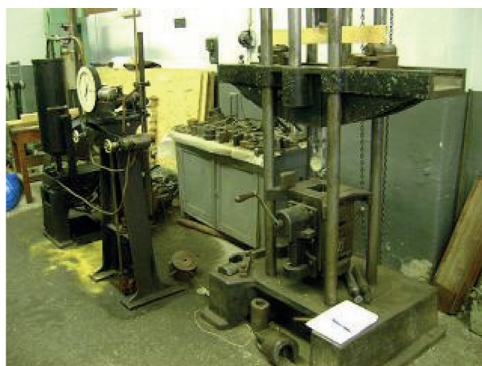
Рис. 21. Гидравлический пресс ИМ-50
